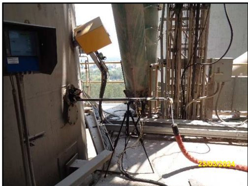
ภาพที่ 3.2 การตรวจวัด TSP, โลหะหนัก จากปล่องหม้อเผา
