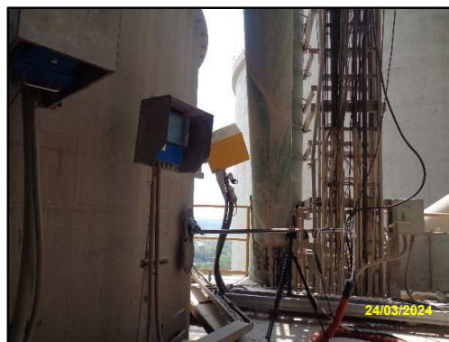
ภาพที่ 3.5 การตรวจวัดไดออกซิน จากปล่องหม้อเผา
